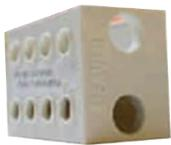
适用于EP管和15 mL离心管。可同时使用8个1.5 mL（或2 mL）EP管，或2个15 mL离心管 |
